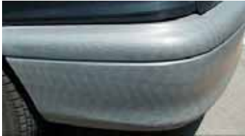
図4 PPバンパーの外観不良の例
