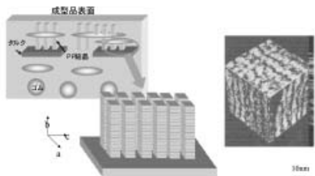
図4 四角柱構造の模式図と電子顕微鏡写真
